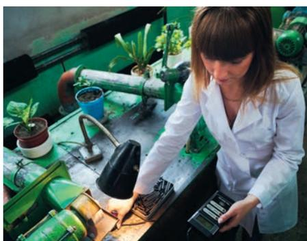
*Измерение параметров световой среды рабочего места цеха точной механики*
