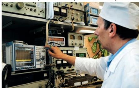
*Анализатор спектра и сигналов цифровой обработкой обеспечивает высокие точность и воспроизводимость измерений*
