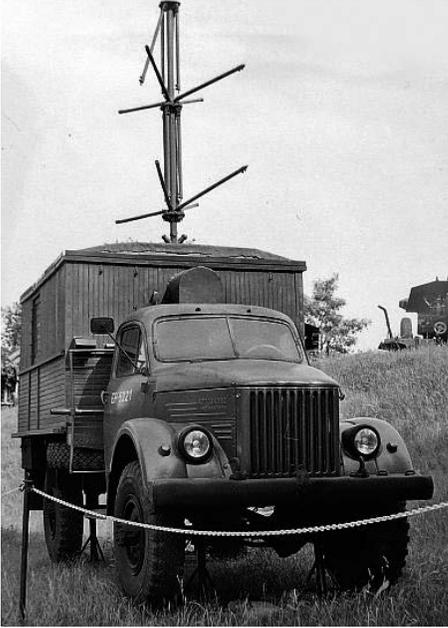
Радиолокационная станция «Мост-2» кругового обзора на шасси ГАЗ-63Э. 1955 год
