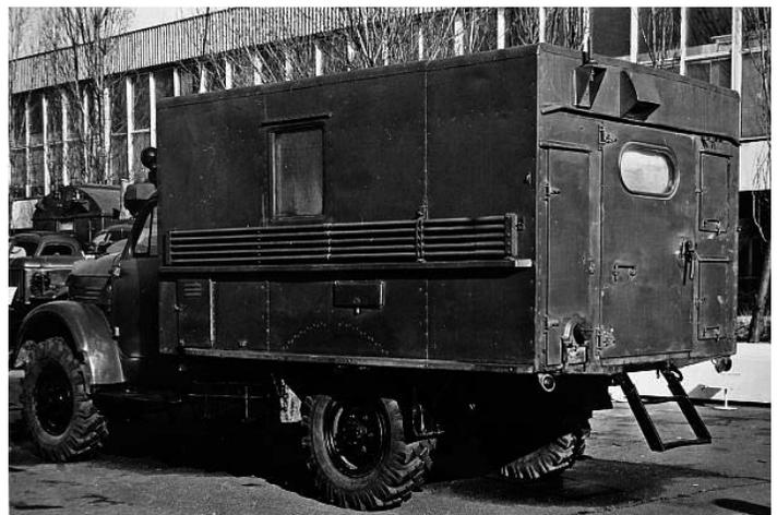
Радиостанция Р-103М на шасси ГАЗ-63Э со специальным металлическим кузовом. 1962 год
