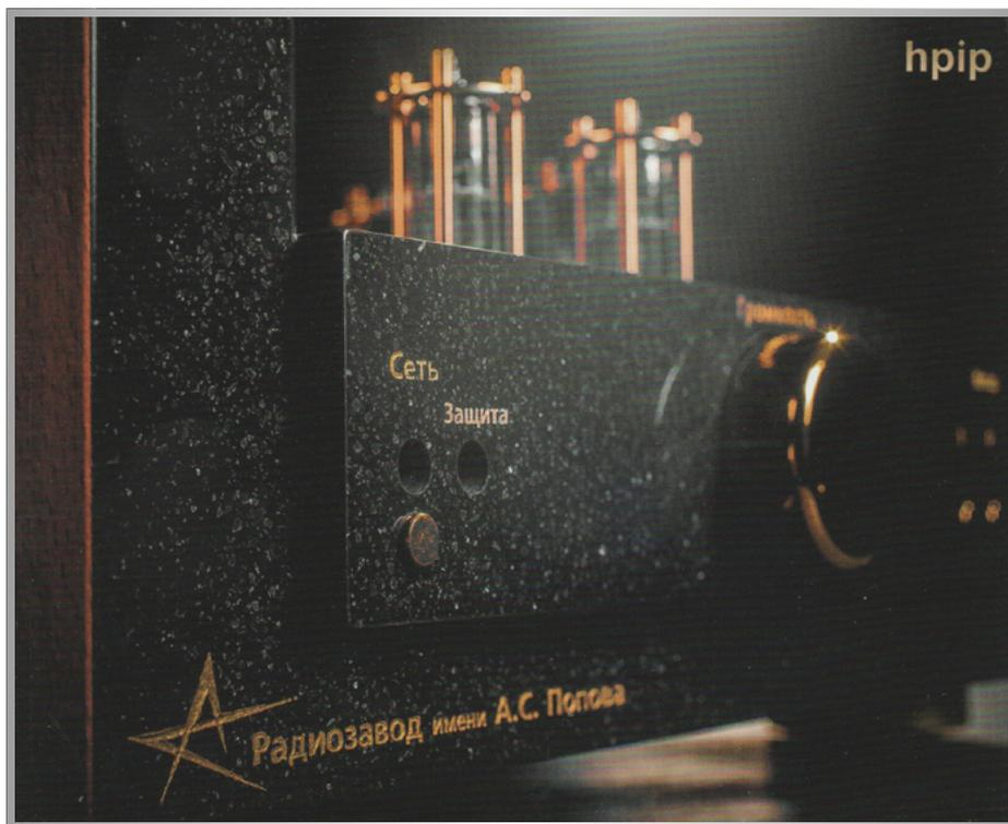
как уже говорилось, на службу звуку. Для нее специально отбирают лампы, провода изготавливают из чистого серебра, бескислородной меди и паяют серебряными припоями, используют позолоченные контакты. Конечно, такая аппаратура собирается вручную и не может стоить дешево.
