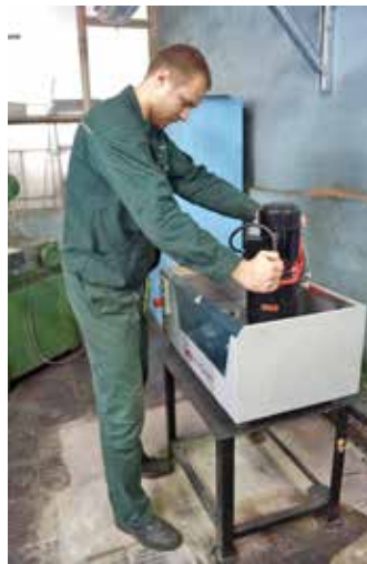
Заточка пуансонов на специализированном станке для заточки инструментов ValuGrind
