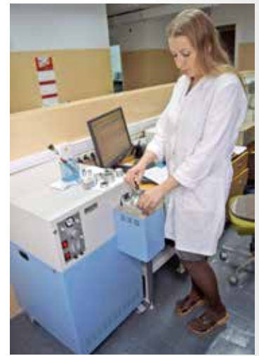
Производится спектральный анализ на оптико-эмиссионном спектрометре ДФС-500
