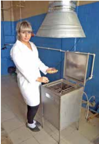
Пропитка моточных изделий лаком на ультразвуковой установке УЗС 4-30ПТ
